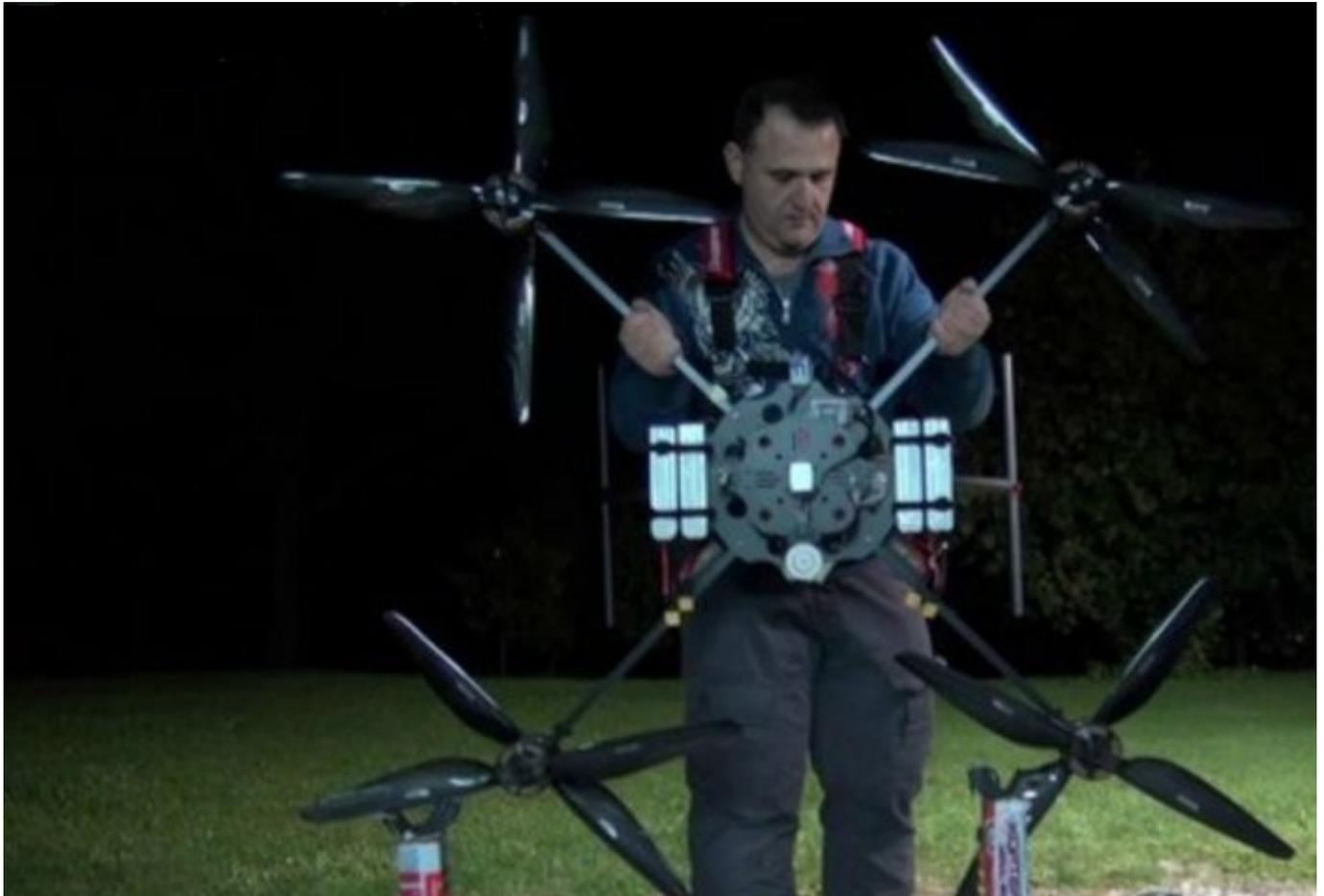
Un drone per utilizzo professionale dalle dimensioni imponenti e caratteristiche di tutto rispetto. In grado di alzare 25 Kg totali di cui 15 di carico pagante e con una autonomia di volo sino a 60 minuti a seconda del payload.
