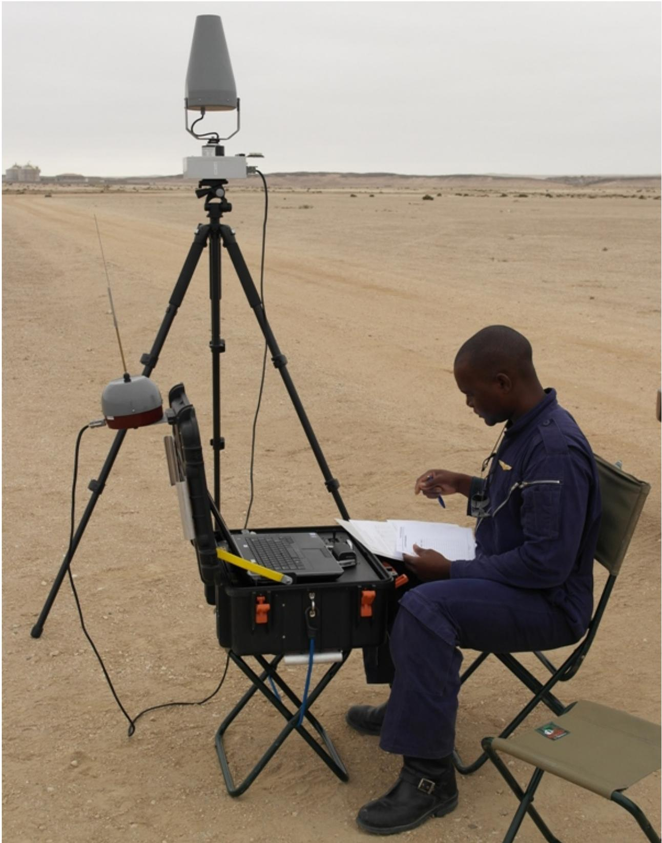
I test sono stati eseguiti per 4 giorni da Gabriel Shatumbu che tra l'altro è un vero pilota civile, grazie alla ground station con antenne direttive con auto tracking (inseguimento e puntamento del velivolo) al fine di ottenere sempre il massimo segnale video e data link.
