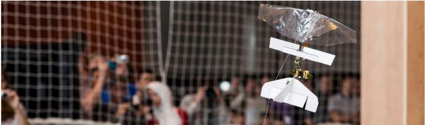
*Un Micro Aerial Vehicle (MAV) completamente autonomo in grado di decollare, atterrare e volare evitando ostacoli nell'ambiente nel quale si trova.*
