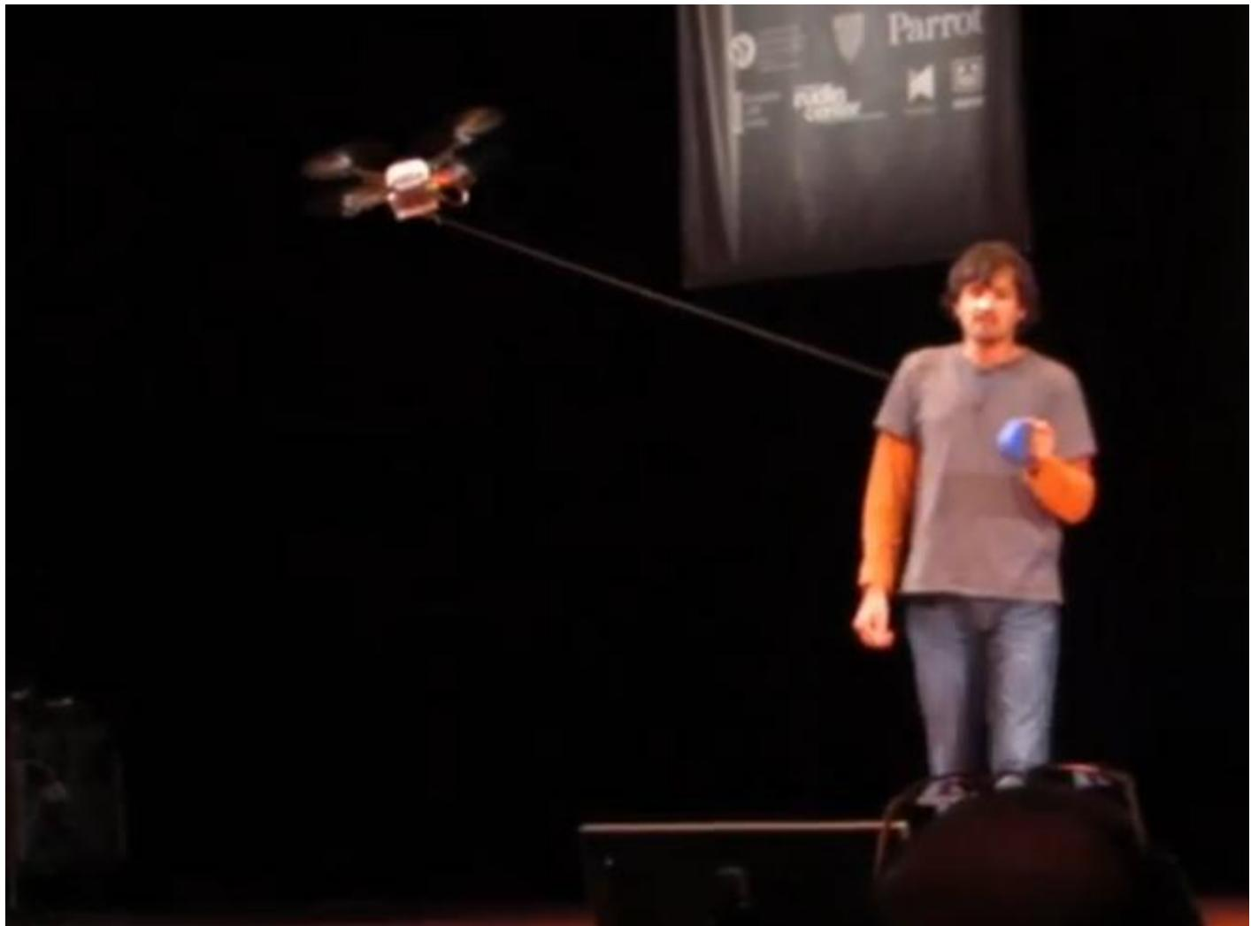
*Un drone sperimentale, collegato ad un cavo di rete e di alimentazione che può essere utilizzato per eseguire rilievi di carattere video fotografico, mantenendo sempre lo stesso angolo di ripresa.*
