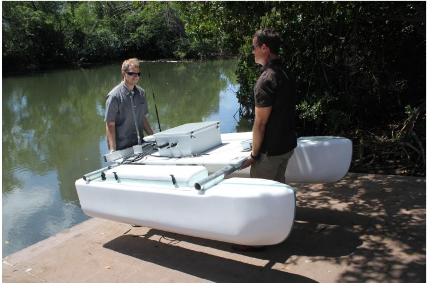
Il UPSV è una piattaforma robotica progettata per supportare le operazioni di pattugliamento da parte della guardia costiera, dispone di sensori sonar, in modo multi-beam e side-scan e sensori chimici per poter misurare l'inquinamento in acqua prosegue il Dott. Bingham.
