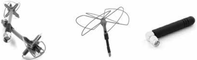
Diversi tipi di antenna per FPV: da drstra Cloverleaf, Mushroom e stilo, quest'ultima da evitare a bordo del drone ma può essere usata in certi casi sul ricevitori Diversity, accoppiata a un'antenna di tipo differente.
