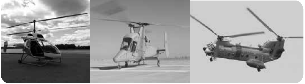
Tre diversi esempi di elicotteri con rotori controrotanti: da sinistra a destra due rotori coassiali (Rotorfly), due rotori intersecanti (Kaman) e due rotori alle estremità (Boeing)
